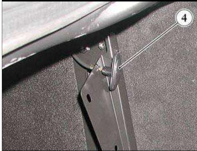
■ 将支架安装到行李箱中并连接打开燃油箱活门 (4) 的安全操纵杆。
