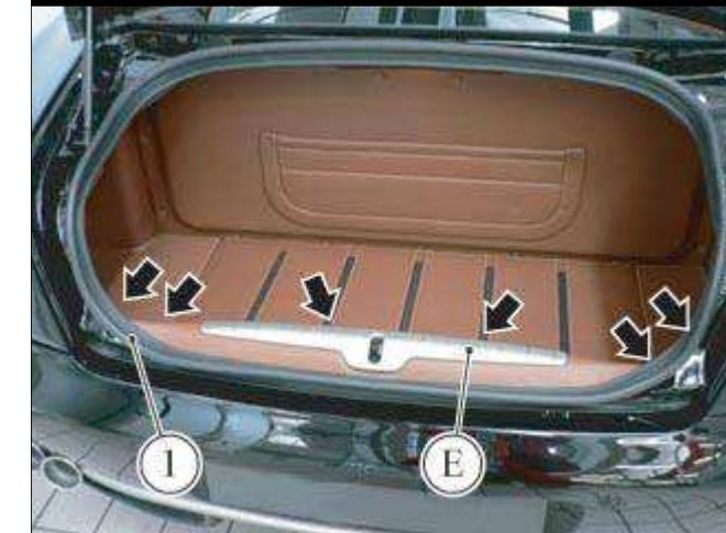
● 将后饰板 (E) 以及行李固定器放置到其底座中, 使用指示的六个螺钉将其紧固并安装外围行李箱饰件 (1)。
