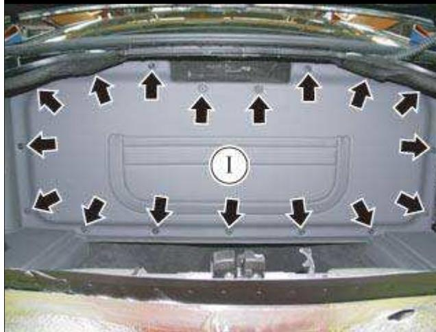
■ 放置油箱壁饰件 (I) 并拧紧 17 个外围紧固螺钉。
