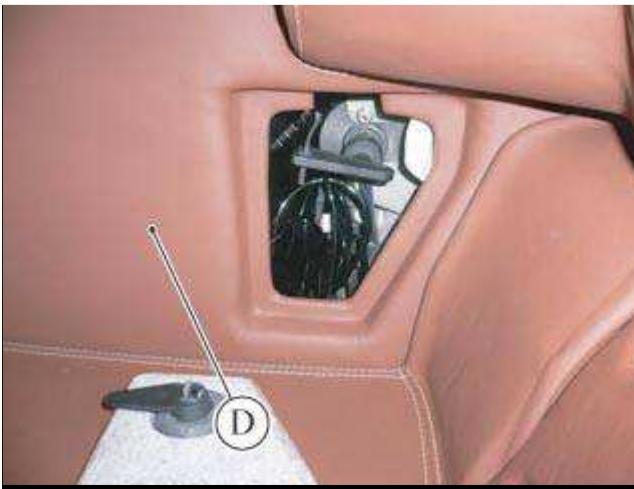
■ 放置并安装右侧挡泥板饰件 (D), 然后安装行李箱的外围密封条。
