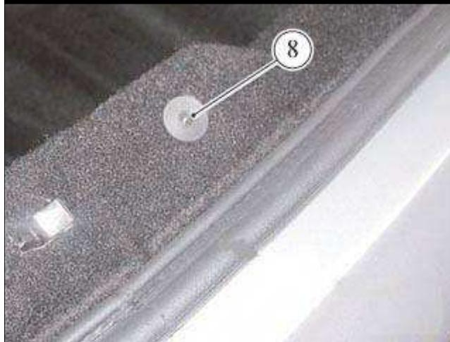
● 放置打开行李箱的止推垫圈并拧紧螺钉 (8)。
