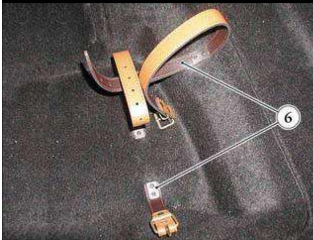
● 使用带有适当螺旋钻头的钻, 钻掉紧固铆钉顶部, 然后拆卸夹持物体 (6) 的皮带。
