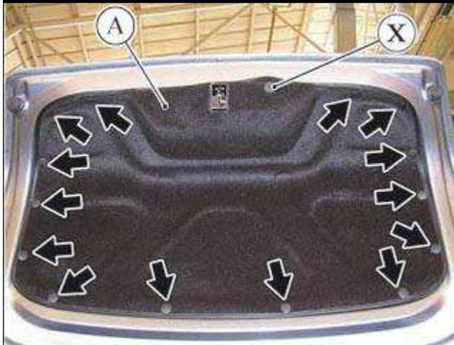
■ 将后盖放置在饰件 (A) 内, 安装 14 个指示的固定按钮和盖 (X)。
