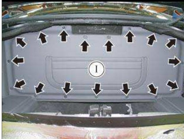
● 拆卸 17 个周边紧固螺钉并拆卸油箱壁饰件 (I)。
