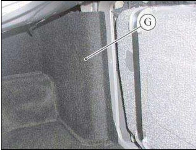
● 拆卸左侧车轮室挡泥板垫 (G)。
