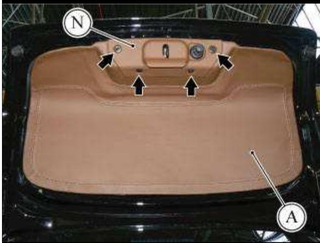
● 将后盖 (A) 的内侧饰件放置到其座中并将内侧连接嵌入件放置到盖上。
