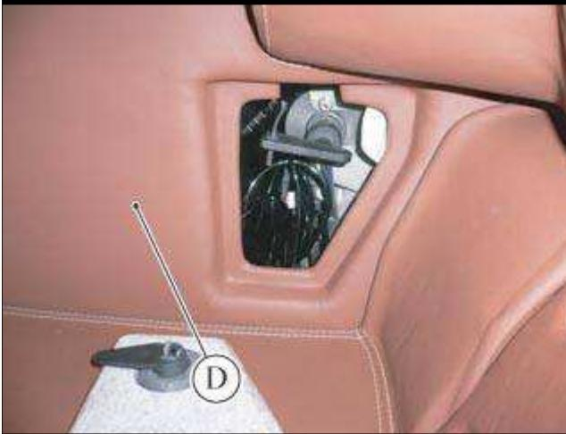
要拆卸右侧车轮室挡泥板饰件 (D), 不必拆卸蓄电池断开盖; 只需移开行李箱的周边衬垫并拉出右侧挡泥板饰件 (D)。
