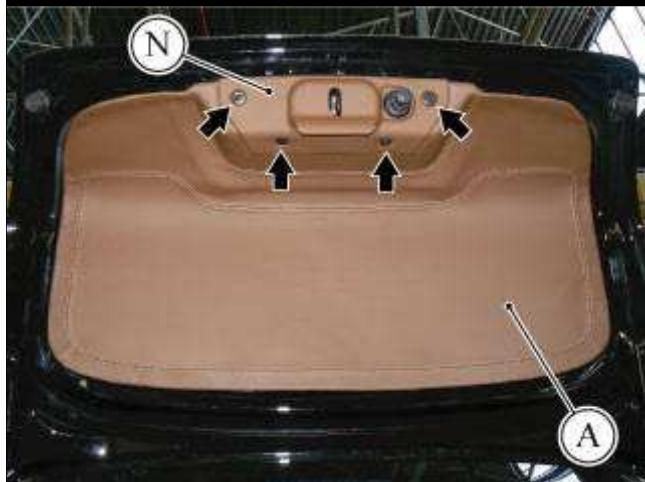
● 通过拧下 4 个螺钉拆卸固定板 (N)。
