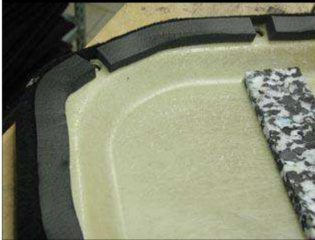
● 在装回行李箱壁的垫之前，检查与车身接触的周围密封条状况，并在磨损时更换。
