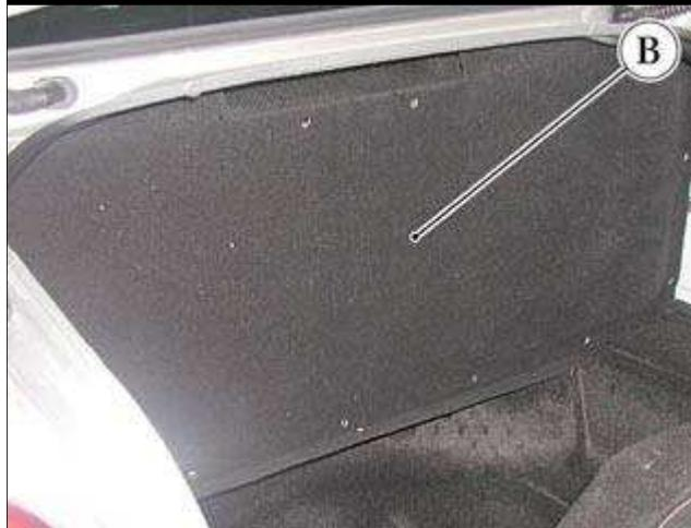
■ 拆卸 17 个周围紧固螺钉并拆卸油箱壁垫 (B)。
