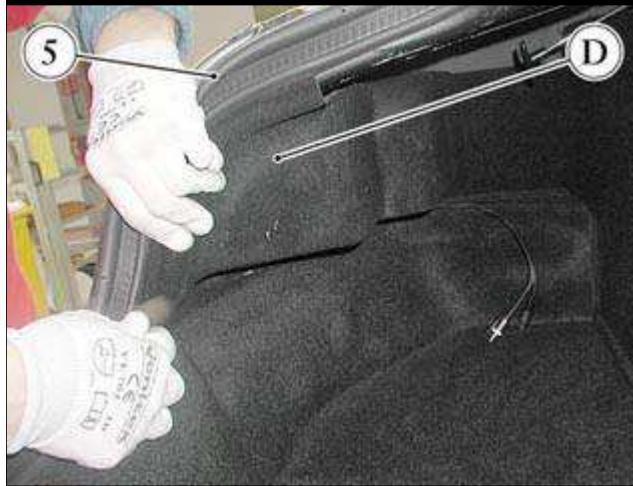
■ 部分拆卸行李箱 (5) 的密封圈并拉出灯罩垫 (D)。
