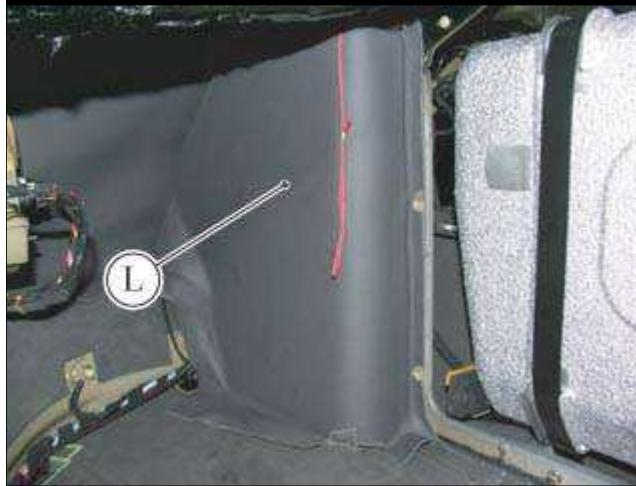
■ 放置并安装左侧轮拱罩饰件 (L)，使用用于内衬右侧的双面胶带。
