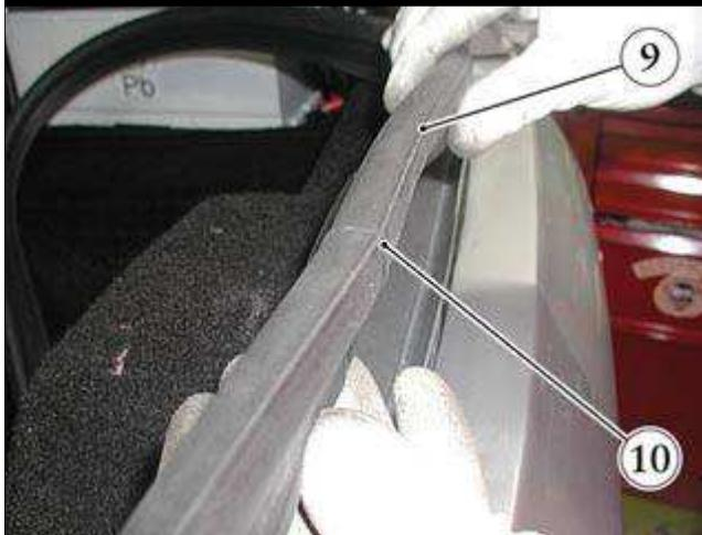
● 在重新安装行李箱周围密封条时，确保安装方向正确。
