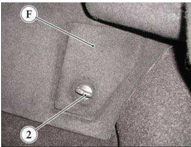
■ 安装蓄电池断开盖 (F) 并将紧固件转动 90° (2)。
